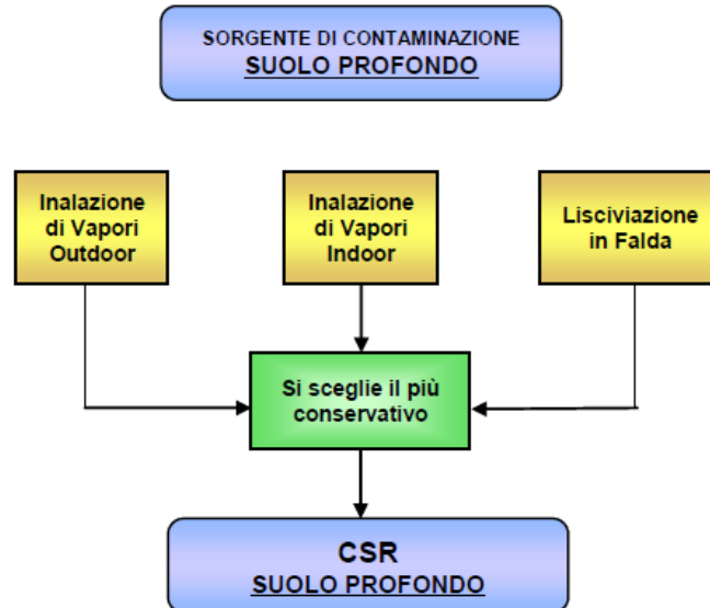
Figura 4 - Criterio di cumulazione per più vie d'esposizione per il calcolo della CSR individuali per sorgenti nel suolo profondo.
