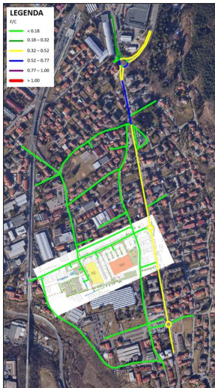
Figura 38 - Scenario SDP del venerdì mattina. Flussogramma flusso/capacità della rete dell'area di studio
