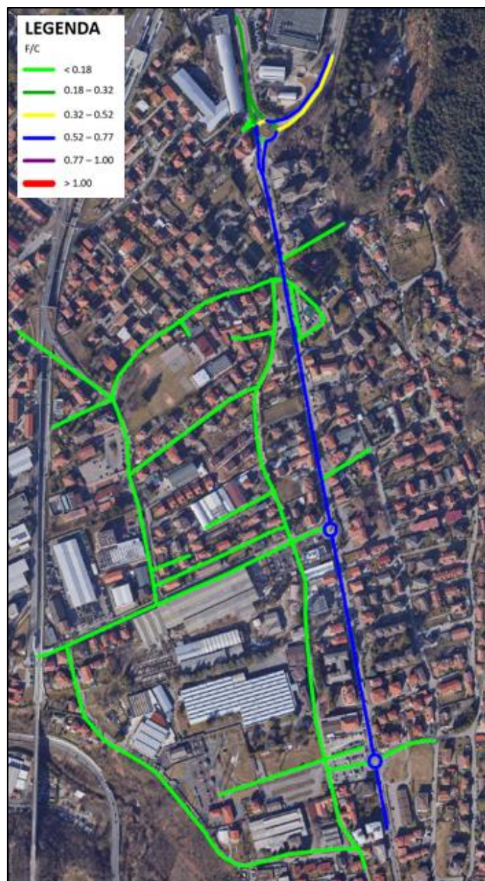
Figura 26 - Scenario SDF del venerdì sera. Flussogramma flusso/capacità della rete dell'area di studio
