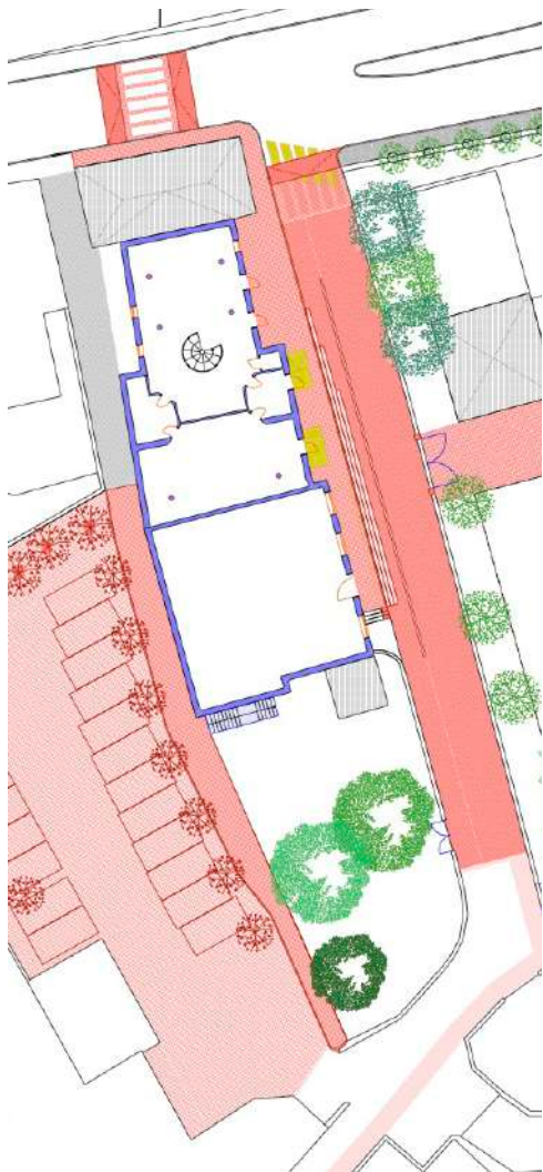
Gialli Rossi Demolizioni e Ricostruzioni
