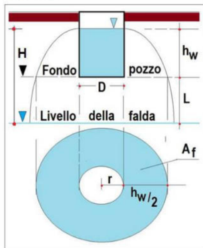
Figura 5 Equazione di Sieker per il calcolo della portata di drenaggio del pozzo
