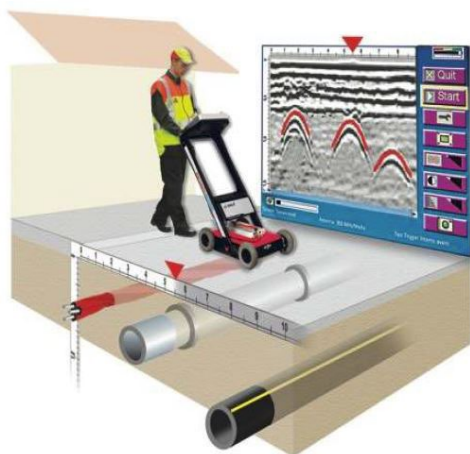
Esempio: Indagine georadar di sottoservizi
