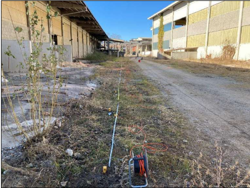
Vista stendimento MASW.
